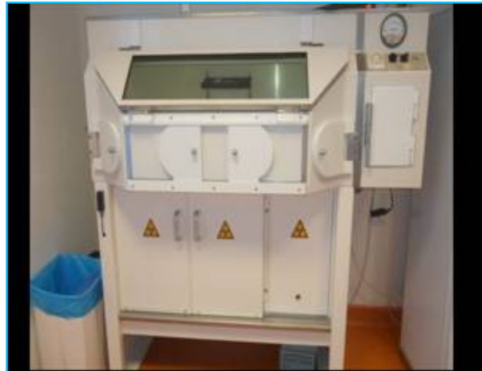
Sous hotte aspirante et isolante plombée
